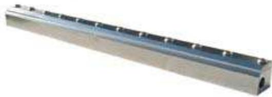
Die Luftmesser produzieren einen Laminarfluß entlang der eigenen Länge. Mit dem Coanda Effekt wird die Luft aus der Atmosphäre angesaugt, was die zugeführte Druckluft bis zum 30-fachen erhöht.
