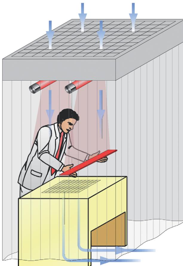
Hochleistungsionisationsstäbe EI VS reichern den laminaren Luftstrom mit positiven und negativen Ionen an. Vorhandene oder erst auftretende Ladungen werden so beseitigt bzw. können erst gar nicht auftreten.
